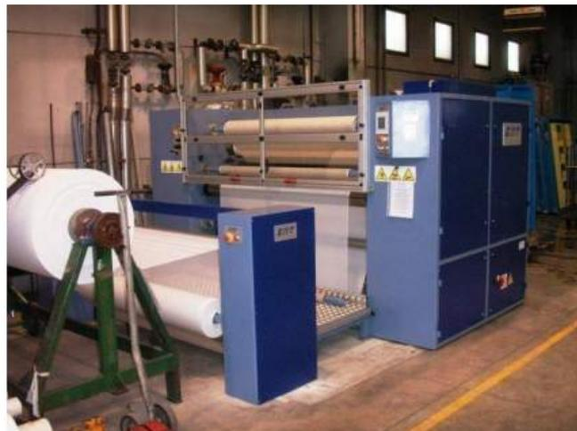
Il riscaldamento è tramite numerose resistenze elettriche oppure, a richiesta, a circolazione d'olio da impianto centralizzato. Il feltro è in fibra 100% Nomex, per alte temperature, con sistema di centraggio proporzionale e tensionamento parallelo, costante e regolabile.
