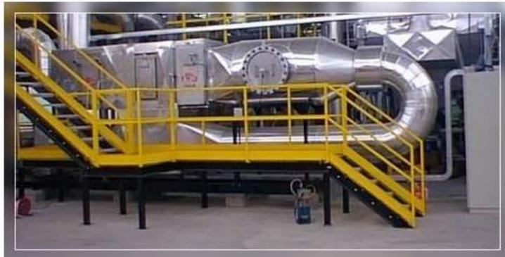
Interconsult Italia Srl ha adottato alcuni accorgimenti tecnici come l'utilizzo di un campo ionizzante, che consente di lavorare a temperature minori sul catalizzatore, e di scambiatori "heat pipes" per recuperare il calore derivato dall'ossidazione, al fine di minimizzare i costi di gestione.
