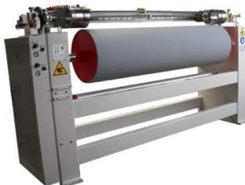
Spalle in lamiera d'acciaio grosso spessore, saldate a scatola con traverse tubolari di legamento. Cilindro microforato "serigrafico", sviluppo 640 mm., con calotte in alluminio, rapidamente sostituibile con cilindro di differente disegno.
