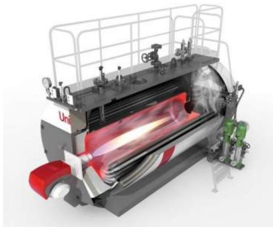
**Caratteristiche generali:** Il generatore ad inversione di fiamma è costituito da focolare cilindrico a fondo bagnato in cui si sviluppa la fiamma e dove avviene l'inversione dei gas di combustione. I fumi quindi imboccano il fascio tubiero in corrispondenza della piastra tubiera anteriore e vengono convogliati verso la piastra tubiera posteriore dalla quale escono attraverso la camera fumi.
