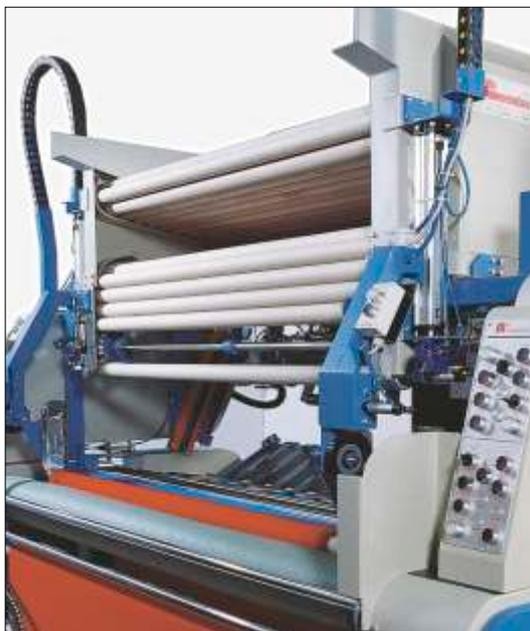
Distributore automatico tubi - Automatic tube distributor
