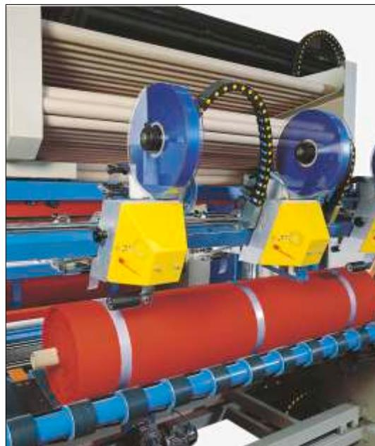
Sistema di reggiatura - Roll end closing system
