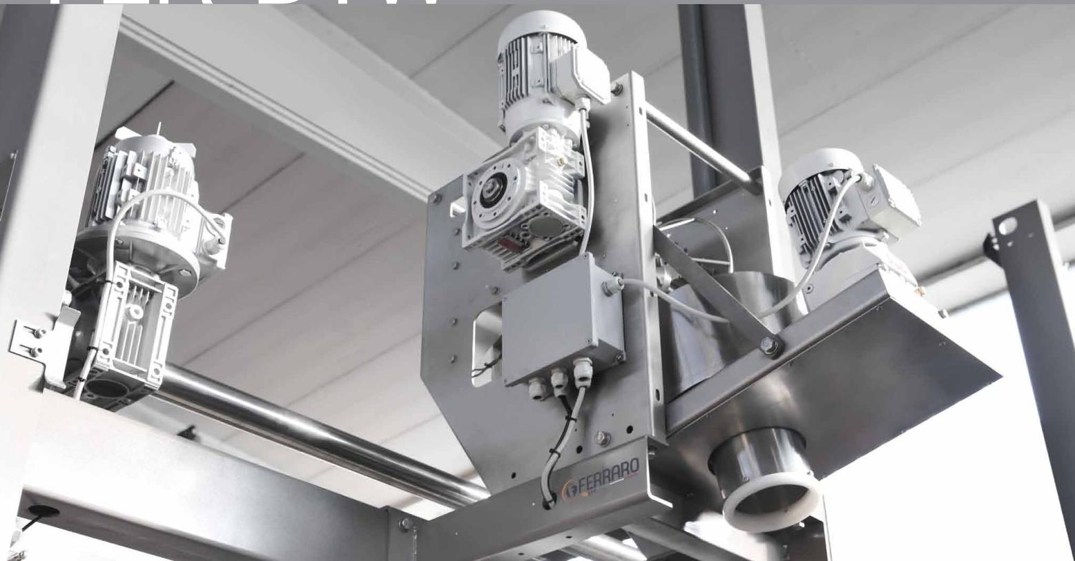
Sistema di svolgitura delle corde di tessuto proveniente dalla fase di tintura, è fatto interamente in acciaio inossidabile per poter resistere ad ambienti umidi. Il sistema può essere integrato con una piattaforma rotante per guiderne la rotazione.
